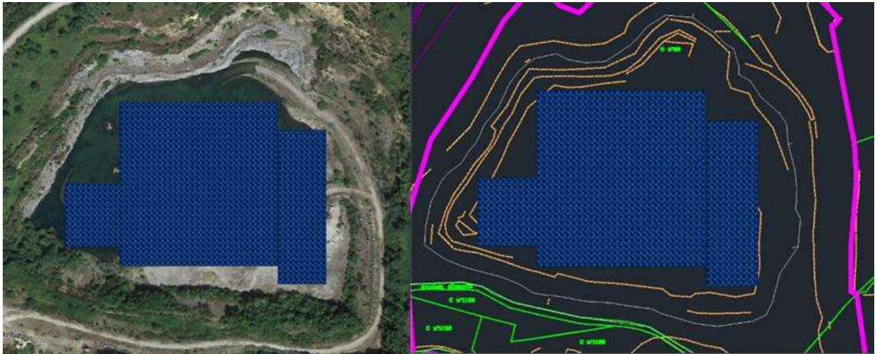
Figure 10: Calepinage préliminaire site de Parnac
